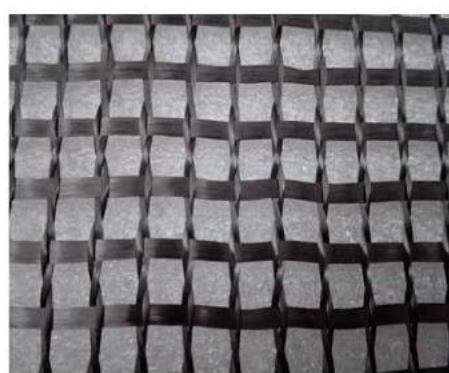
شكل پ-۲۱-۶- نمونه‌ای از شبکه الیافی
